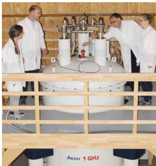
Prof. Dr. Paul Rösch (2.v.r.) und Mitglieder seiner Arbeitsgruppe führen eine Proteinprobe in den Magneten des 1-GHz-Spektrometers ein, um die Konformation des Proteins zu untersuchen. Foto: Jürgen Rennecke
